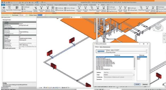
Tool zum interaktiven 3D-Planen in Revit in Verbindung mit SOLAR-COMPUTER-Berechnungen für Heizungs/Kälte-Rohrnetze, Auslegungen von Heizflächen sowie den hydraulischen Abgleich. Auto-matisches Generieren und Platzieren von Verbrauchern in Revit aus der Berechnung für Standard-Fälle. GBIS-Bedienelemente in der Revit-Oberfläche bieten Möglichkeiten für höchste Arbeits-effizienz bei Neuplanungen, Projektänderungen oder zum Varianten-Vergleich.
